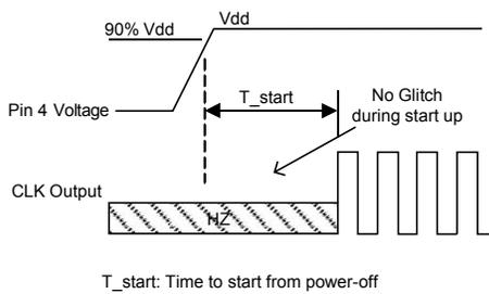
Figure 4. Startup Timing (OE/ $\overline{ST}$  Mode)<sup>[9]</sup>
