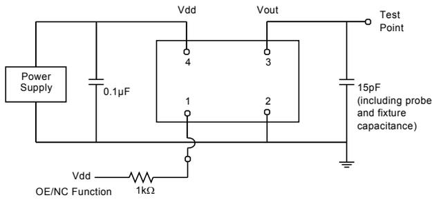
Figure 2. Test Circuit<sup>[8]</sup>
