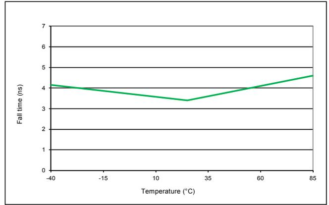
Figure 15. Fall Time vs Temperature<sup>[9]</sup>
